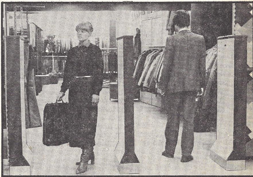
foto 1 — Beveiliging tegen winkeldiefstal. In de zuilen zijn antennes, zend/ontvangers en synthesizers geplaatst. De wafer bevestigd aan een kledingstuk zorgt voor detectie (zie foto 12).
